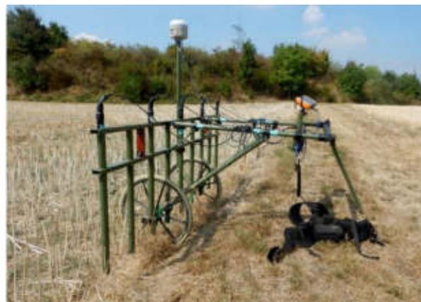
Fotos: Mehrkanalige Fluxgate-Magnetometer mit Sonden der Fa. Sensys auf der zu untersuchenden Fläche
