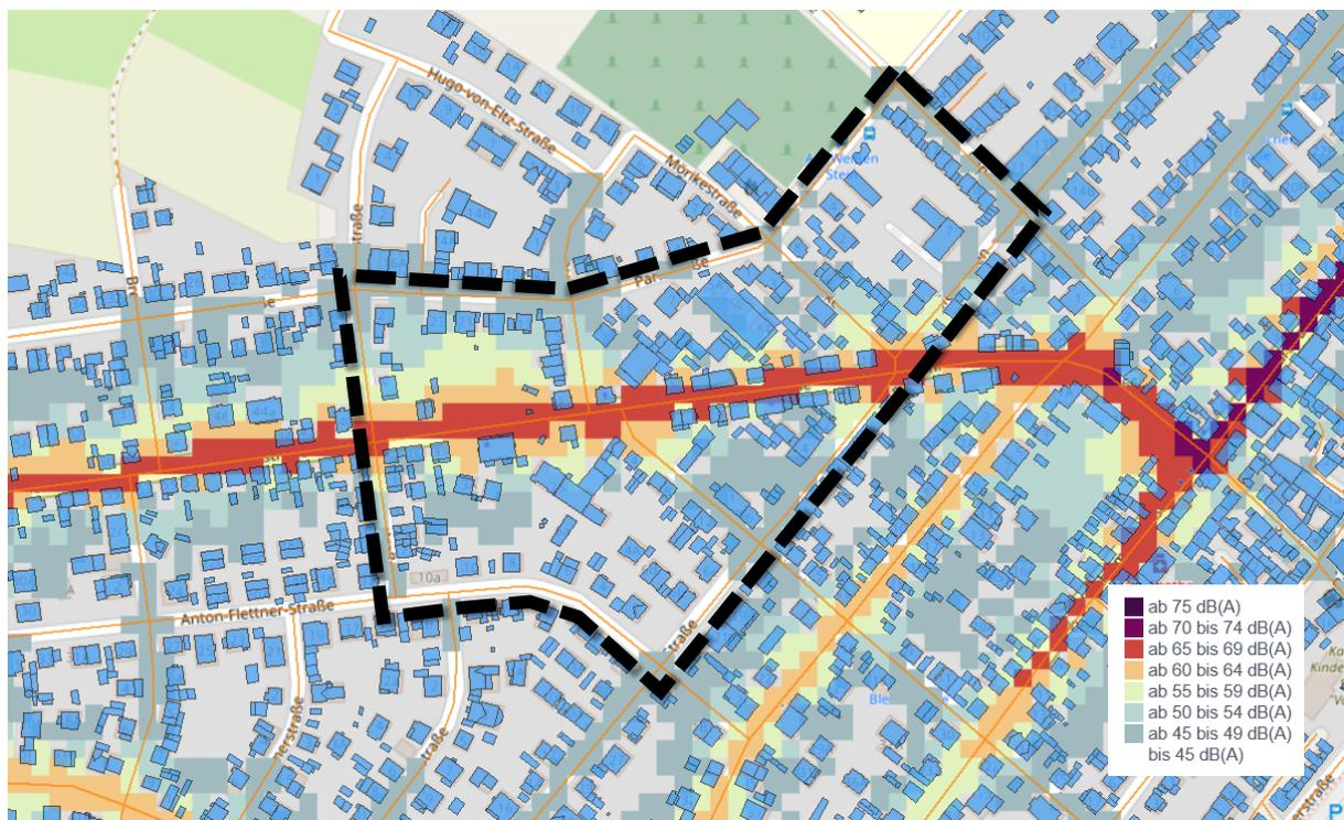
Abb.: Umgebungslärmkartierung Hessen 2022 Lärmpegel Tag, berechnet auf Basis der RLS 90<sup>22</sup>
