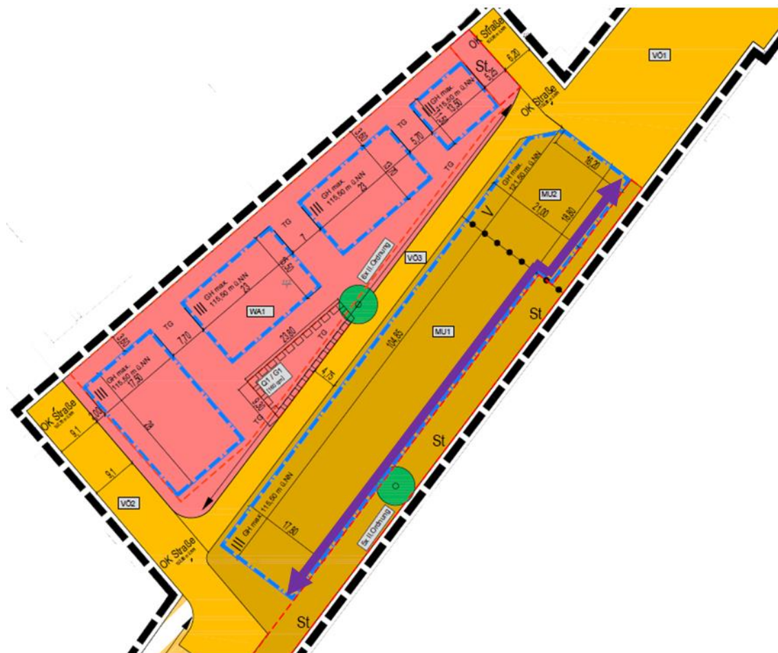
Abbildung 2: Auszug Bebauungsplan mit Eintragung der Schallschutzmaßnahme 2 (Akustisches Gutachten A80298d/5506, Büro IAB)
