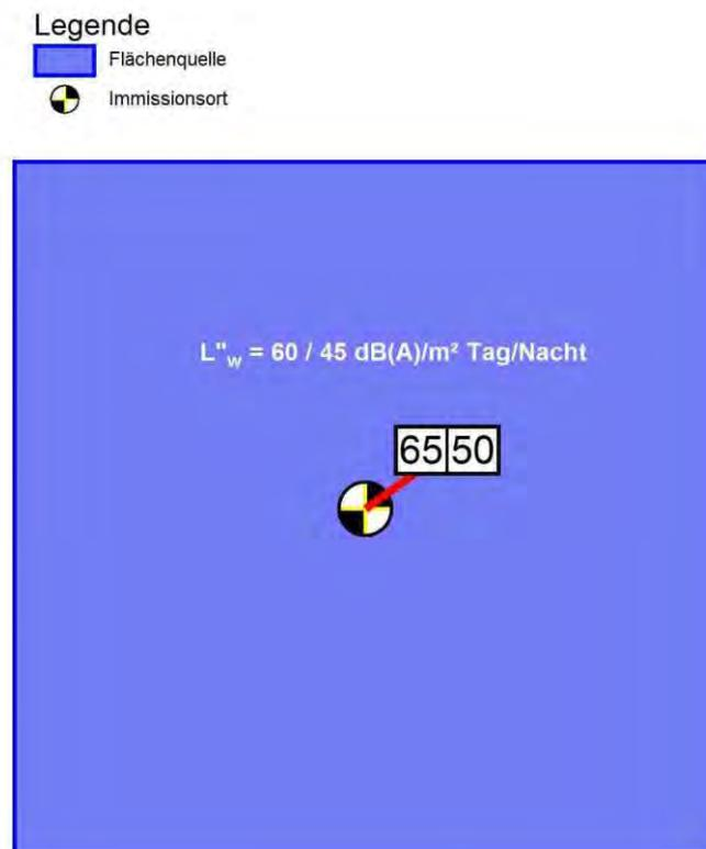
Die Abbildung zeigt beispielhaft, dass bei der genannten Schallemission einer Flächenschallquelle an einem Immissionsort, der am ungünstigsten Punkt der Fläche, auf der sich die Flächenschallquelle in einer Höhe von 2,00 m über Gelände befindet, platziert ist, sich Geräuscheinwirkungen (Beurteilungspegel) von
