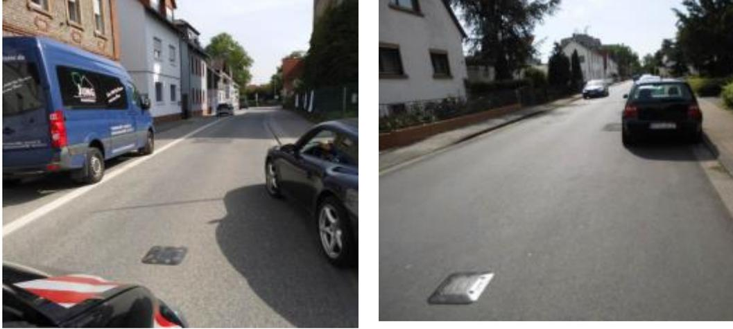
Abbildung 6: Erfassungsgerät mit Magnetfeldtechnologie am Querschnitt 1 und 2
