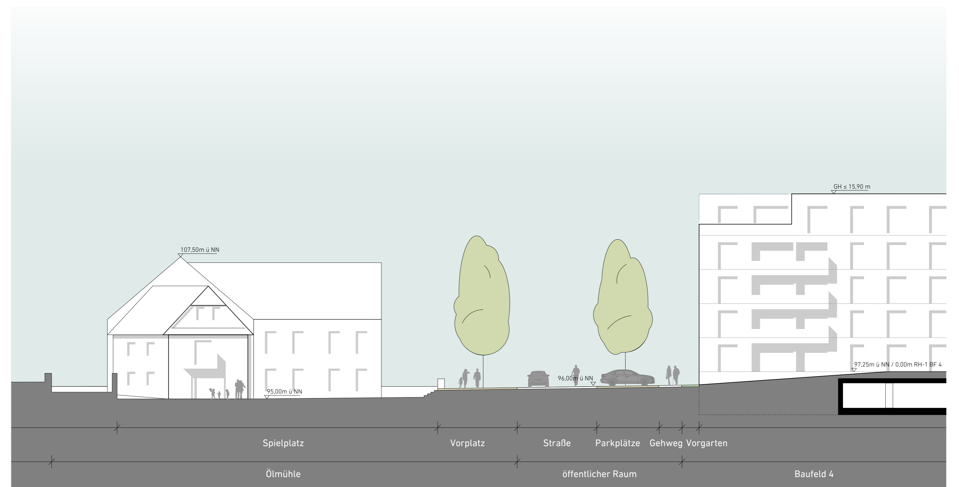
Detailschnitt C-C Straßenraum Verlängerung der Wasserwerkshaussee M 1:200
