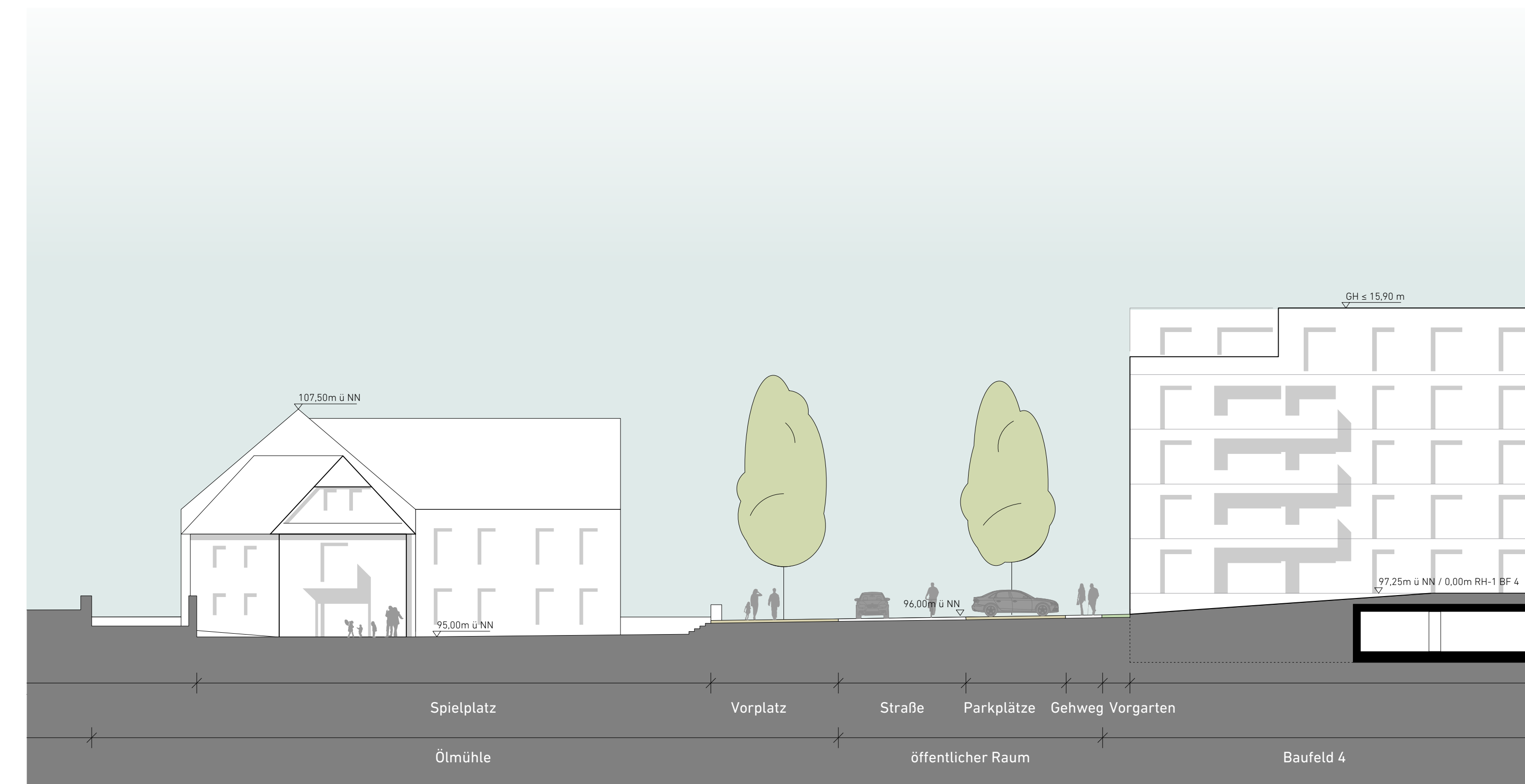
Detailschnitt C-C Straßenraum Verlängerung der Wasserwerkshaussee M 1:200
