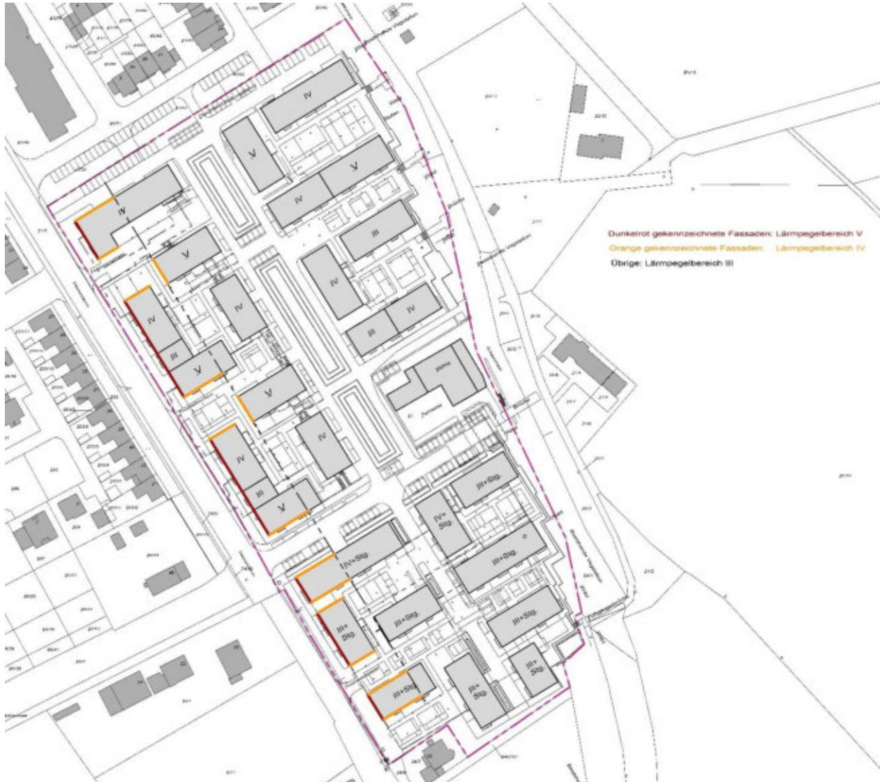
Abb. 7: Darstellung der Fassadenbereiche mit Anforderungen nach den Lärmpegelbereichen IV und V
